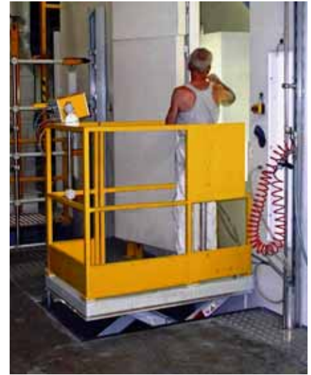
Bild 5 Diese Scherenhebebühne hat eine maximale Arbeitshöhe von einem Meter. Der Bediener ist – z. B. bei einem Fehltritt nach hinten – dank des Geländers auf der gesamten Hubhöhe vor einem Absturz geschützt. Je nach Arbeitsplatzsituation kann ein Geländer bereits bei einer geringeren Absturzhöhe als 500 mm erforderlich sein.
